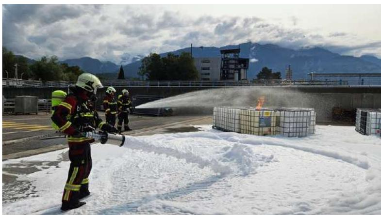
Mise en place d'un dispositif d'extinction à l'aide d'un tapis de mousse
