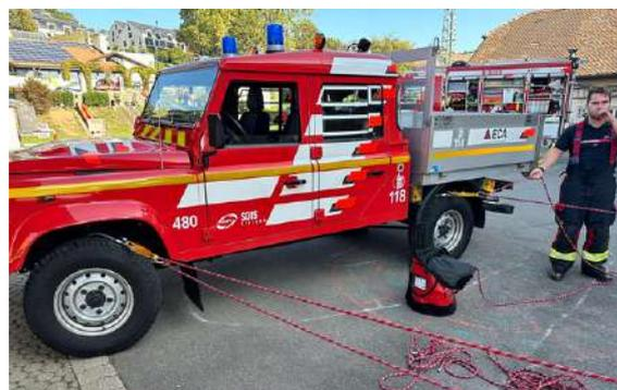
L'antichute : mettre en place un système antichute en passant par la façade d'un toit
